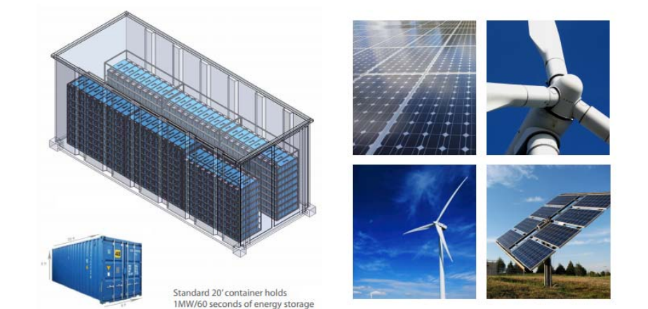
图 33：超级电容在电网储能中的应用(1MW 功率下输出 60s)
